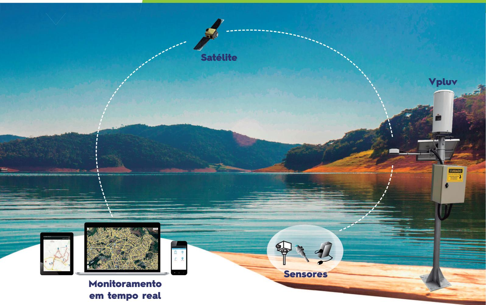
A solução utiliza uma remota satelital conectada a sensores ou dataloggers para coletar e transmitir informações de monitoramento via satélite. As informações são captadas por um sistema de gestão que acompanha o status da comunicação e permite a integração com sistemas corporativos em tempo real.
